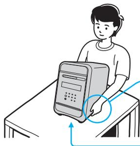
本機を持ち上げるときは、左右から手を入れて底面を持つ。前面および後面パネル部分に手をかけて持たないでください。本機を置くときは、衝撃が加わらないように静かに置く。
