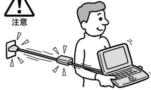
接続したまま移動させると電源コードや接続ケーブルが傷つき、火災や感電の原因となったり、接続している機器が落ちたり、倒れたりしてけがの原因となることがあります。
