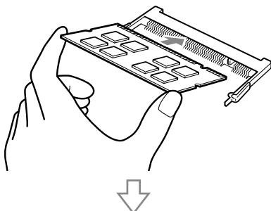
② メモリーモジュールの両端を、両手を使って押し、「カチッ」と音がするまで倒す
