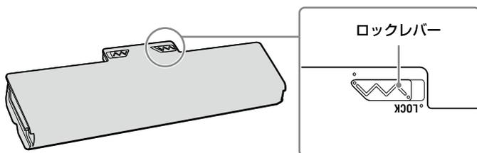
3 バッテリー取り付け部両端の凸部とバッテリー両端の溝をあわせる。
