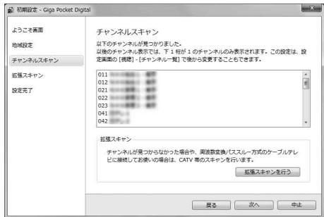
表示されたチャンネルが少ない場合は、[戻る]をクリックして前の画面に戻り、アンテナの接続を確認したうえで再度[開始]をクリックしてください。
