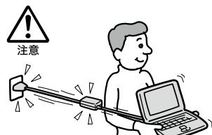
接続したまま移動させると電源コードや接続ケーブルが傷つき、火災や感電の原因となったり、接続している機器が落ちたり、倒れたりしてけがの原因となることがあります。また、本機を落とさないようにご注意ください。
