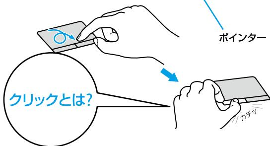
タッチパッドの上で指を動かして、目的の場所の上までポインターを移動し、左ボタンを「カチッ」と1回押してすぐに離します。これを「クリックする」または「左クリックする」と言います。
