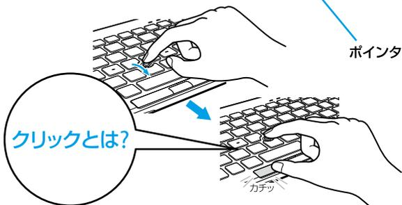
スティックポインターを指で動かして、目的の場所の上までポインタを移動し、左ボタンを「カチッ」と1回押してすぐに離します。これを「クリックする」または「左クリックする」と言います。
