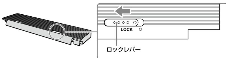
3 バッテリーと本機が平らになるように、本機のバッテリー取り付け部にバッテリーをあわせる。
