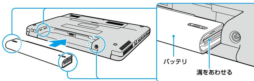
4 ロックレバーを外側(LOCK側)にずらして、バッテリーを固定する。
