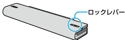
3 バッテリー取り付け部とバッテリー両端の溝をあわせ、「カチッ」と音がするまでバッテリーを差し込む。
