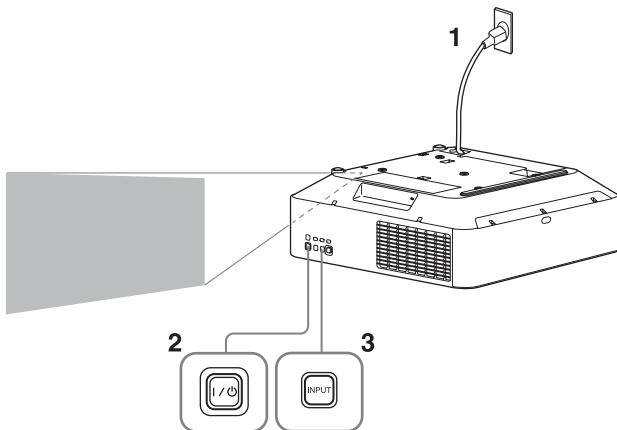
**1** Conecte el cable de alimentación de CA a una toma de pared.
