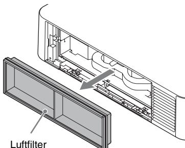
**6** Reinigen Sie den Luftfilter mit einem Staubsauger.
