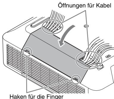
Beispiel für die Kabelanordnung an der Abdeckung
