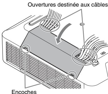
Exemple de disposition des câbles dans le cache
