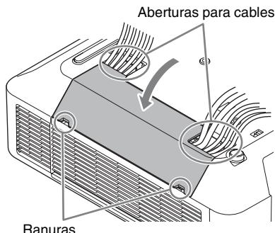
Ejemplo de disposición de los cables en la cubierta
