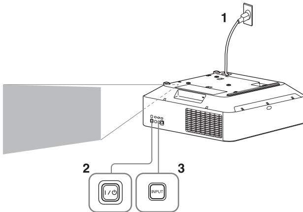
**1** Collegare il cavo di alimentazione CA a una presa a muro.
