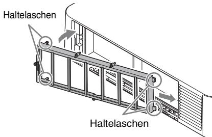
**8** Setzen Sie die beiden Haltelaschen an der seitlichen Abdeckung in das Gehäuse ein und schieben Sie die seitliche Abdeckung nach oben.
