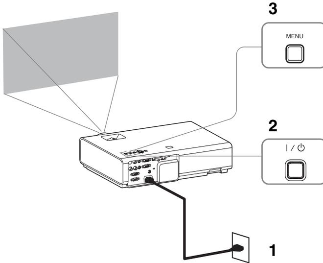
**1** Stecken Sie den Stecker des Netzkabels in die Netzsteckdose.
