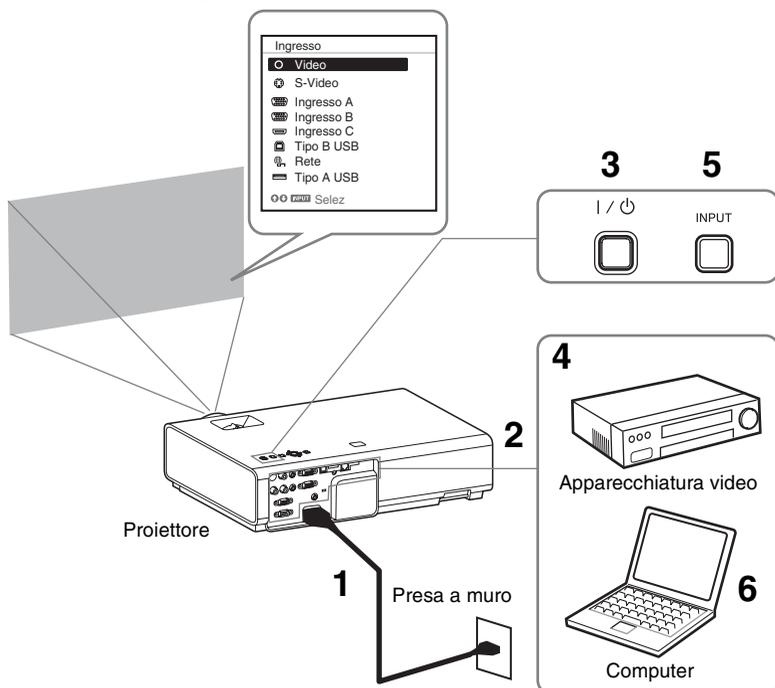
**1** Inserire il cavo di alimentazione CA nella presa a muro.
