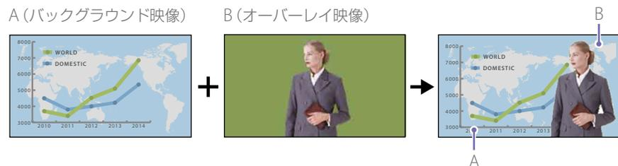
本機では、5種類のクロマキーパターンを用意しています。事前準備として、ライブ操作で使用するパターンアイコンを選択し、キーの合成具合を調整します。パターンアイコンには、キー合成の調整値も設定されます。
