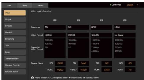
**【Connector】**：1～4の入力で有効になっている入力端子が表示されます。
