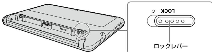
3 バッテリー取り付け部両端の凸部とバッテリー両端の溝をあわせる。
