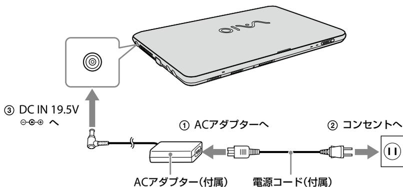
1 電源コードのプラグをACアダプターに差し込む。
