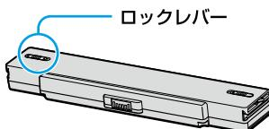
② バッテリ取り付け部とバッテリ両端の溝をあわせ、「カチッ」と音がするまでバッテリを差し込む。
