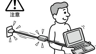
接続したまま移動させると電源コードや接続ケーブルが傷つき、火災や感電の原因となったり、接続している機器が落ちたり、倒れたりしてけがの原因となることがあります。また、本機を落とさないようにご注意ください。
