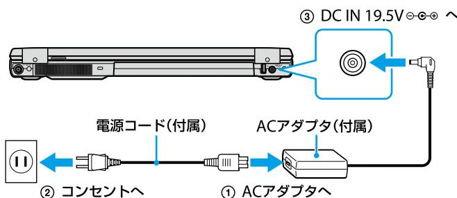
1 電源コードのプラグをACアダプタに差し込む。
