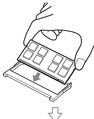
② メモリモジュールの両端を、両手を使って押し、「カチッ」と音がするまで倒す
