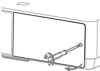
**3** Выкрутите 3 винта блока лампы, затем извлеките лампу за держатель.
