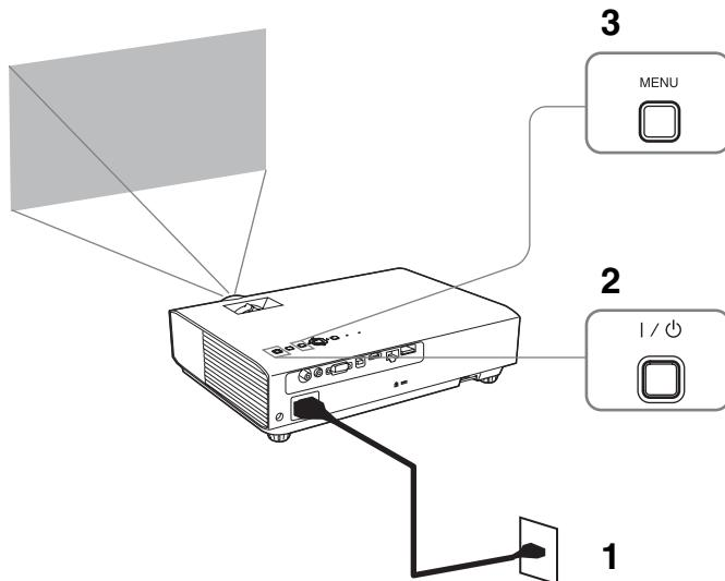
**1** Inserire il cavo di alimentazione CA in una presa a muro.
