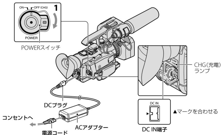
専用の“インフォリチウム”バッテリー (Vシリーズ) を本機に取り付けて充電します。
